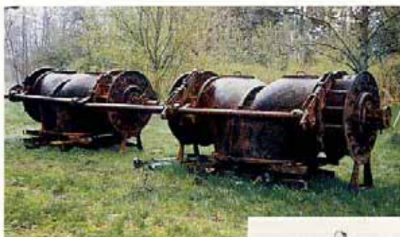
Dobbelt Francis-turbine ved Vestbirk Vandkraftværk. Den har i 60 år været monteret neddykket i et vandfyldt kammer. Nu er den udskiftet efter tro tjeneste.
