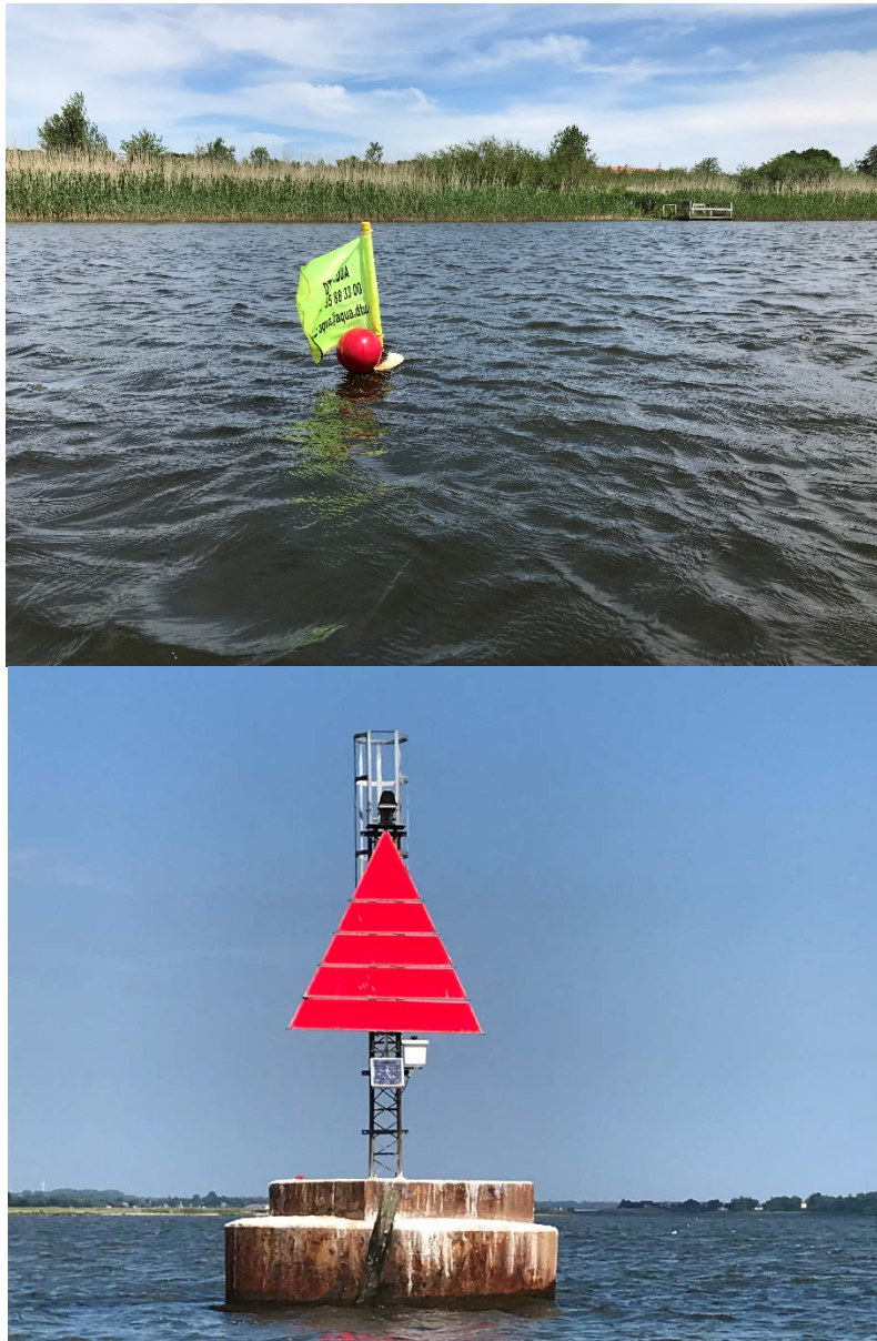
Figur 2. Lyttestationerne blev placeret med et synk på bunden, bundet til en hvid vage og forsynes med navn og telefonnummer (eksempel i øverste billede) eller fastgjort på de faststøbte sejlrendemærker i fjorden (eksempel i nederste billede) fotos: Jes Dolby.
