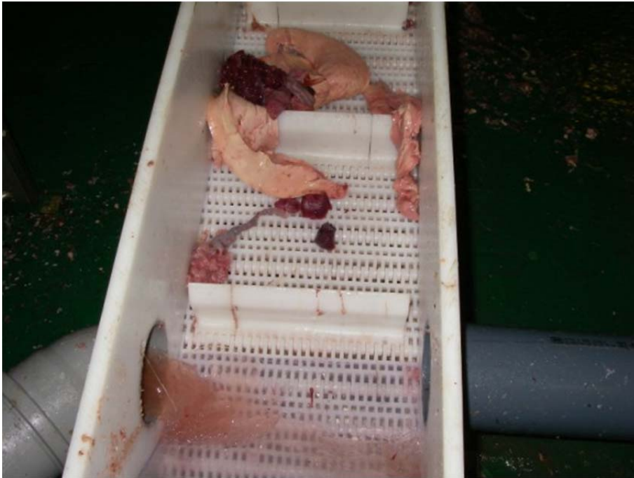
Figur 19: Afdrænedede lever og indvolde transporteres til ensilerings tank
