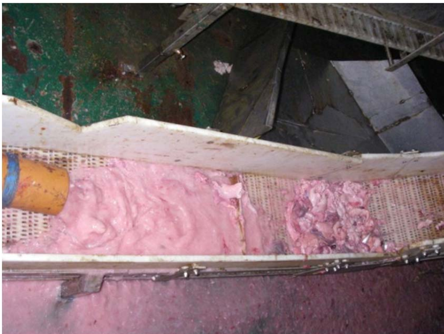
Figur 5: Afdræning af indvolde fra maskin kryvjing og transport til ensilerings tank
