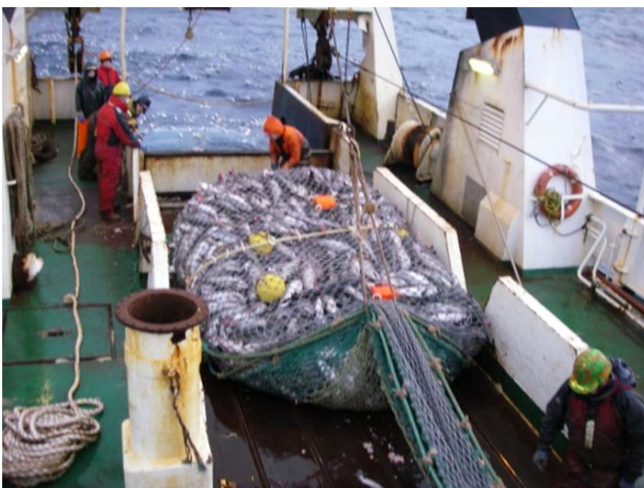
Figur 8: Posen er halet ind og åbnes for at løve ned i de 3 modtage binger
