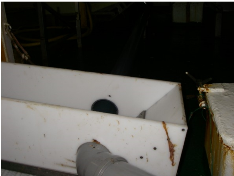
Figur 13: Indløb af lever og indvolde fra hånd og maskin kryvjing på dræn og transport bånd
