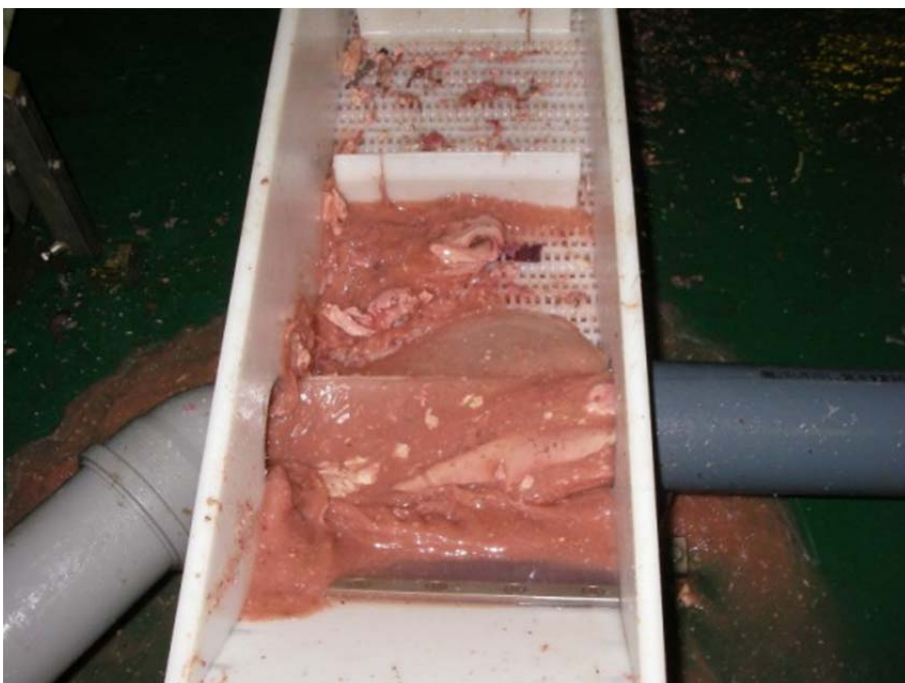
Figur 18: Lever og indvolde fra hånd og maskin kryvjing løber ind på dræn og transport band
