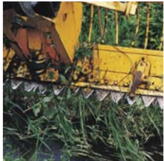
Mejekurven har bevægelige tænder, der kan klippe grøde og kantplanter.
