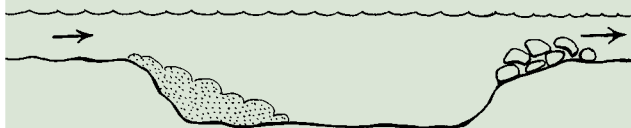
Sandfang fra siden.
