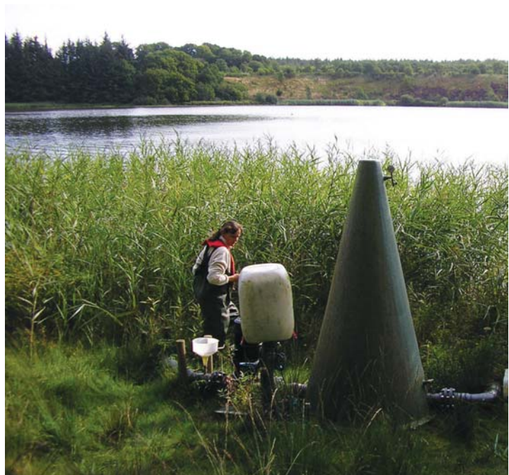
Ilttank og landbaseret iltningkegle anvendt til iltning af Torup Sø i 2004-2006. Foto: Martin Søndergaard.
