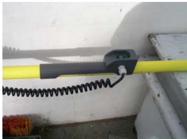
Nærbillede af Stampes Elektros dødemandsknap på 2-hånds elektrode.
