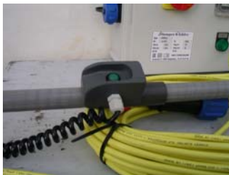
Den forskydelige dødemandsknap på elektrodeskaftet til elektrofisker SE 300
