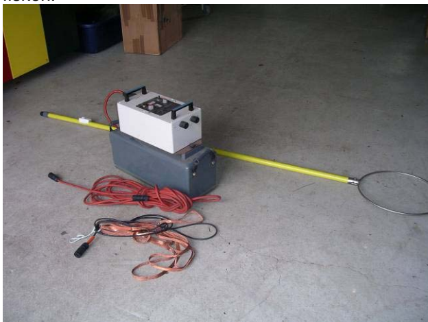
Foto 5: Batteridrevet udstyr til bådfiskeri (tv) og rygbåret batteriudstyr (th).
