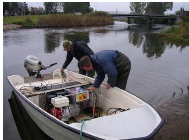
Foto 1: Model EL 63 II, 5000 W (tv.). Klargøring af 5000 W udstyr til fiskeri efter laks i Gudenåen (th.).
