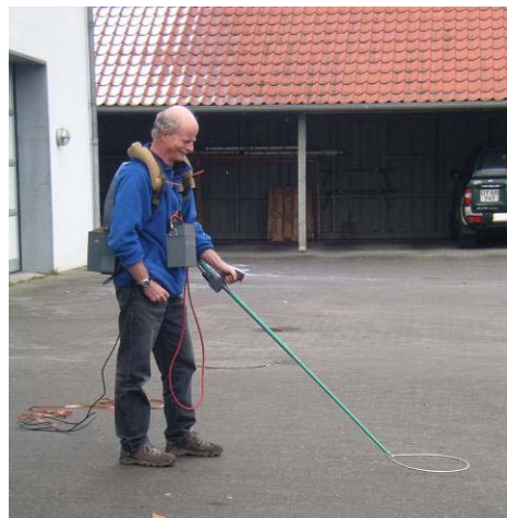
Foto 5: Batteridrevet udstyr til bådfiskeri (tv) og rygbåret batteriudstyr (th).
