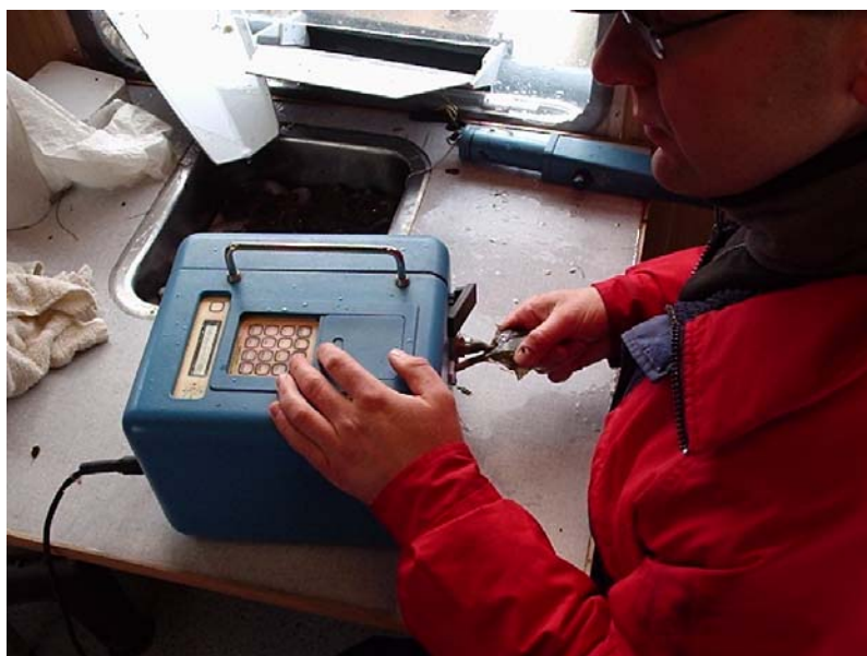
Figur 4. CW-mærkning med mærkningsudstyr. Bemærk opstilling til kontinuerlig tilførsel og afløb til færdigmærkede fisk.
