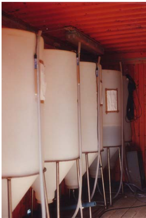
Figur. 4.22. Enkelt anlæg til klækning og berigning af Artemia salina . Klækkekeglerne (hver med et volumen på omtrent 450 l er simpelthen placeret i en gammel container, der er lysstofrør i loftet, HFI relæ, vandtilførsel gennem slanger, lufttilførsel fra en kompressor, luftslanger af haveslange med en afslutning af siveslange samt varmelegemer i kraftig kvalitet (Jäger, 200W). Vandet føres fra keglerne gennem en tud i bunden og gennem en slange, der er hængt op langs siden af keglen.
