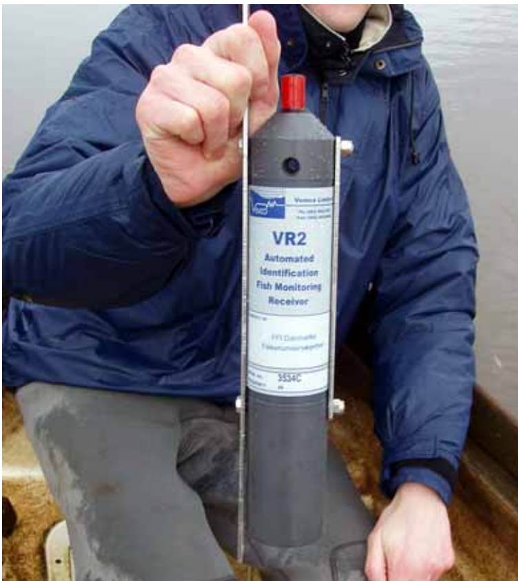
Figur 5. Akustik datalogger, som monteres hængende i et tov under en bøjle med anker, eller hænges direkte på et bolværk. (Foto: Michael Deacon).
