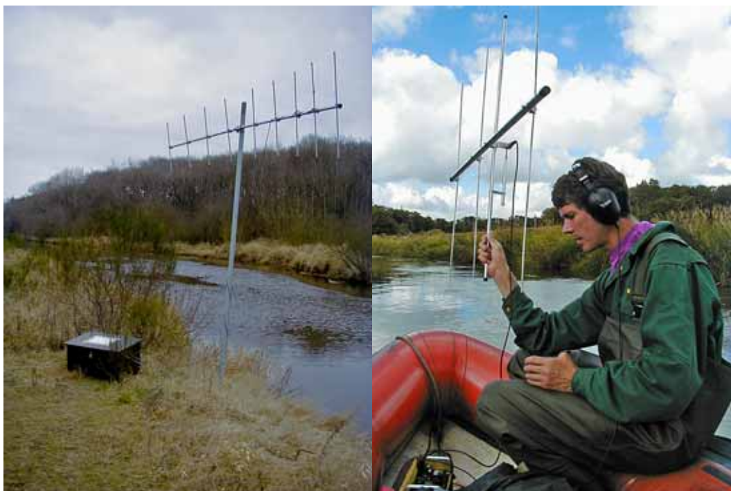
Figur 13. Udstyr til registrering og pejling af radiomærkede fisk. Tv. en dataloggerstation og th. manuelpejling (Fotos: Niels Jepsen).
