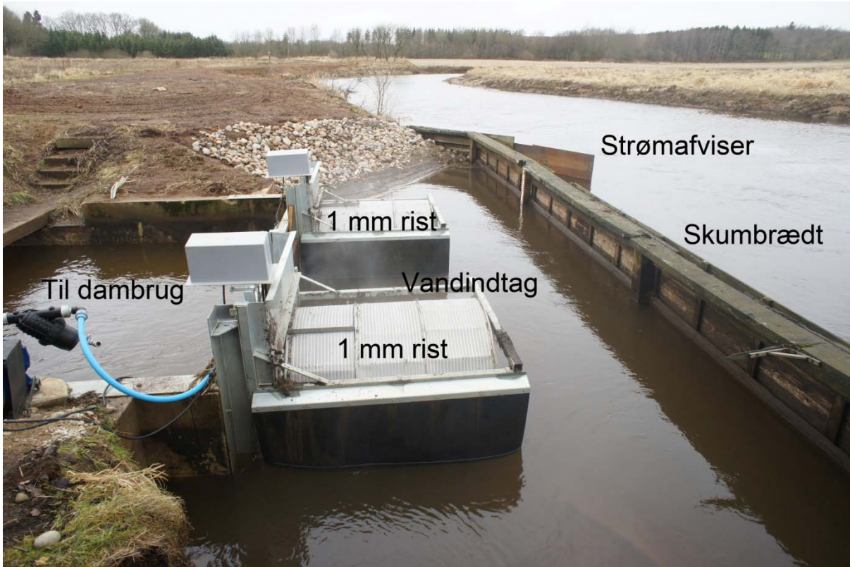
Forsøgsopstillingen ved vandindtaget til Sig Fiskeri, Varde Å, 24. januar 2011.
