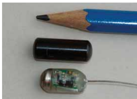
Figur 4. De anvendte sendere i forhold til en alm. blyant. Øverste sender er VEMCO (akustisk), nederste er ATS (radio). Foto: H. Baktoft.
