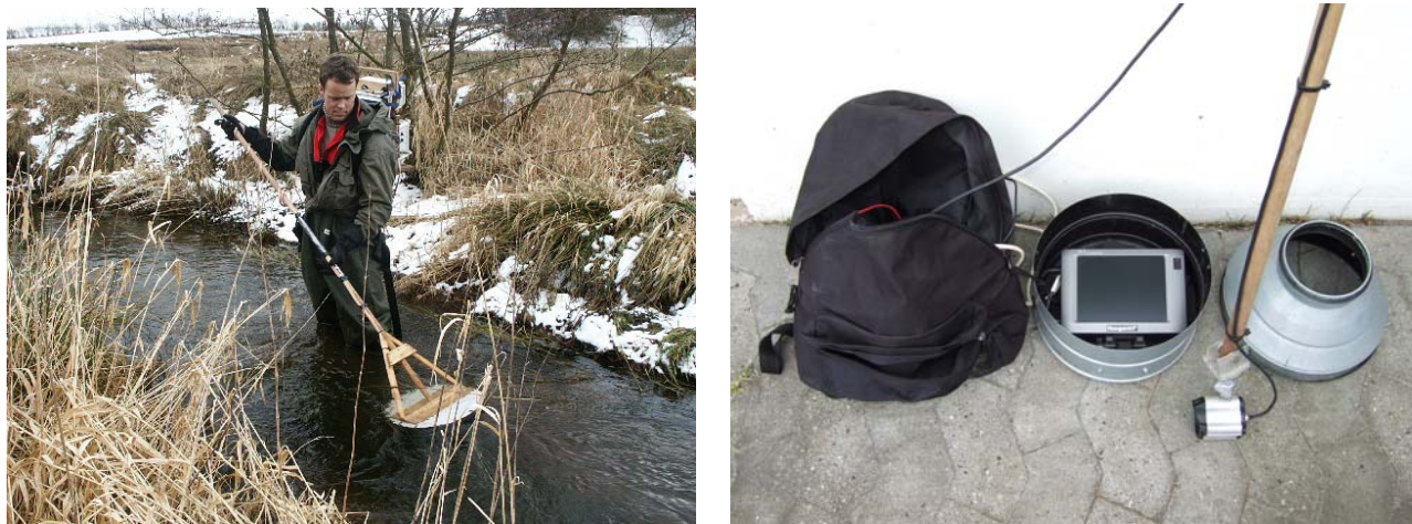
Figur 1: Billedet til venstre viser hvorledes vandløbet afsøges med den transportable PIT-læser. Til højre ses undervandskameraet. Selve kameraet er monteret i enden af træskaftet, og dette sender billedet til den lille fladskærm som bæres på maven vha. rygsækken. Låget til jungen monteres ved observation, for at skærme for sollyset, så billedet bliver skarpere at se på.
