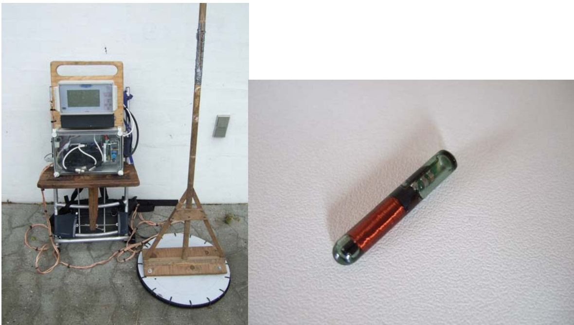
Figur 1: PIT-læser og PIT-mærke. Til venstre ses den transportable PIT-læser som bæres på ryggen. På det lange træskaft er den sammenrullede antenne placeret i PVC-røret under den hvide plade. Til højre ses det 23 mm PIT-mærke.
