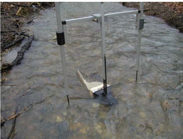
Figur 1: Helley-Smith fælden, som den står under prøvetagning. Fælden stod to gange en halv time både opstrøms og nedstrøms sandfanget ved hver prøvetagning.
